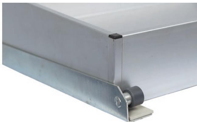
Sfruttando il proprio peso e del suo contenuto il cassetto scorre con i propri pattini sulle fasce in PPL, sorretto da perni in acciaio zincato con rotelle in Nylon. Si estrae e si aggancia in modo sicuro a fine corsa, ribaltando su sé stesso e appoggiandosi al piano e ripiano del proprio vano interno nel quale è inserito.
