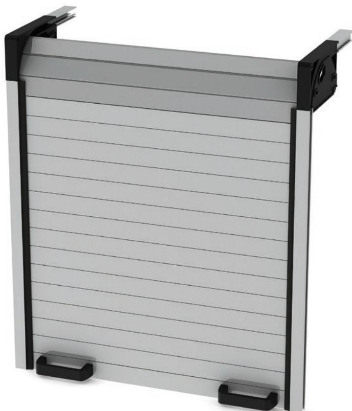
La serranda in alluminio mod. ECO SIMPLY viene assemblata con profili H30 o H38, è realizzata su misura in estrusi in alluminio, con forme e caratteristiche particolari. Questo modello viene utilizzato prevalentemente per chiudere vani porta-materiali di piccole e medie dimensioni, in sostituzione agli scomodi battenti. Viene realizzata su misura ed è anodizzata argento o verniciata Ral 7035. Su richiesta del cliente è disponibile la verniciatura in tutta la gamma dei colori Ral.
