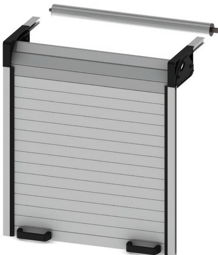
La serranda in alluminio mod. ECO PLUS SIMPLY viene assemblata con profili H30 o H38, è realizzata su misura in estrusi in alluminio, con forme e caratteristiche particolari. Questo modello viene utilizzato prevalentemente per chiudere vani porta-materiali di medie dimensioni, in sostituzione agli scomodi battenti. Viene realizzata su misura ed è anodizzata argento o verniciata Ral 7035. Su richiesta del cliente è disponibile la verniciatura in tutta la gamma dei colori Ral.
