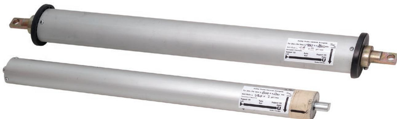
I rulli avvolgitori in alluminio estruso sono disponibili con un diametro 45 oppure 60 mm, in modo da poter offrire una soluzione ad ogni problema d'ingombro. Inoltre sono realizzati con molle in acciaio per garantire la massima robustezza.
